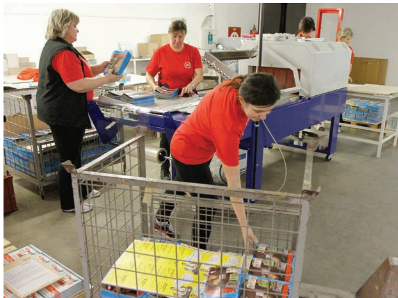
Balení. Poloautomatický tunelový balicí stroj Espert 7555 je pomocníkem pracovníků při balení tiskovin do smrštitelné fólie.
