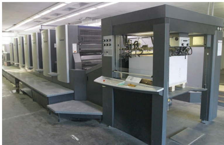
První liga v polygrafii. Heidelberg Speedmaster CD 102-6+L zvládá nejen velkoformátový tisk – má i obačecí zařízení pro oboustranný tisk či možnost tisku a efektové lakování jedním průchodem strojem.
