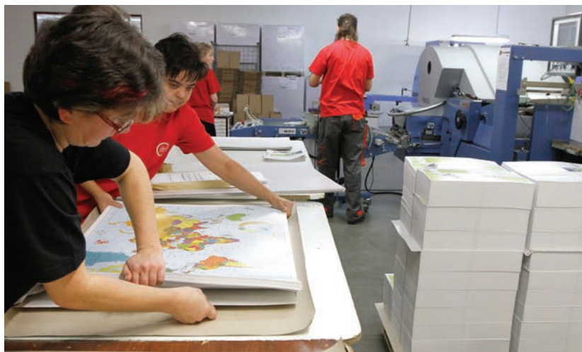
Symbióza práce lidí a strojů. Skládačka papíru Heidelberg Stahlfolder TD 112 Topline dokáže jako jedna z mála v kraji skládat mapy a letáky. Mapy-postery zase balí pracovníci s největší opatrností tak, aby se nepřehnul ani rožek.
